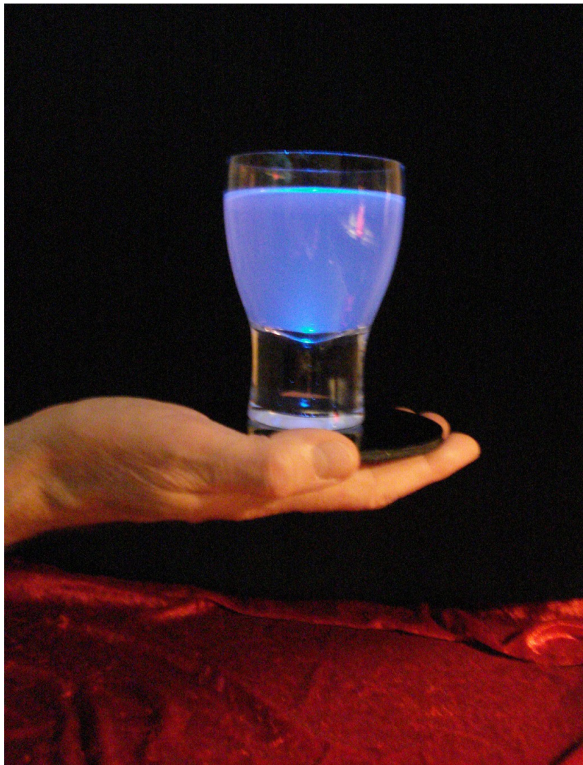
Bild 4.5 Der Bierfilz nach Bild 4.4 im Betrieb. Die Erregerspule befindet sich unsichtbar unter der Tischplatte.
