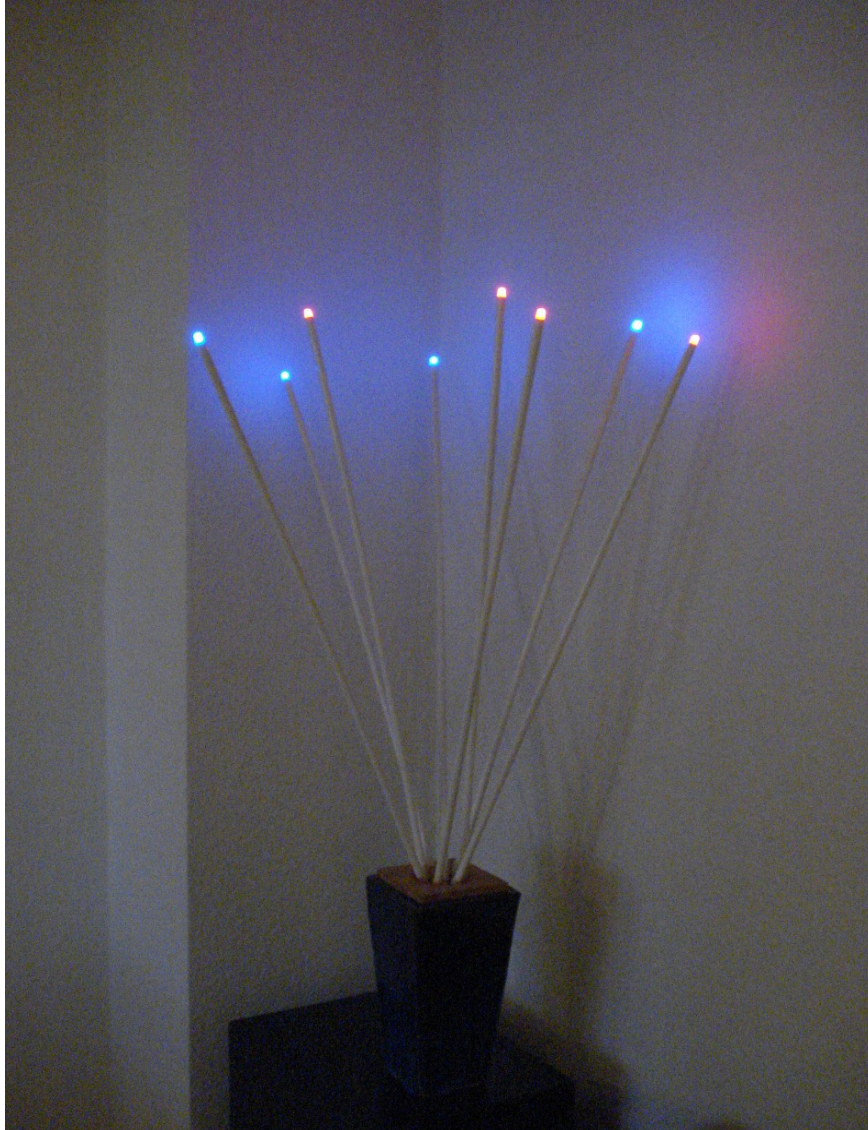
Bild 6.3 Eine Installation. Blumenvase mit induktiv versorgten Blumen.
