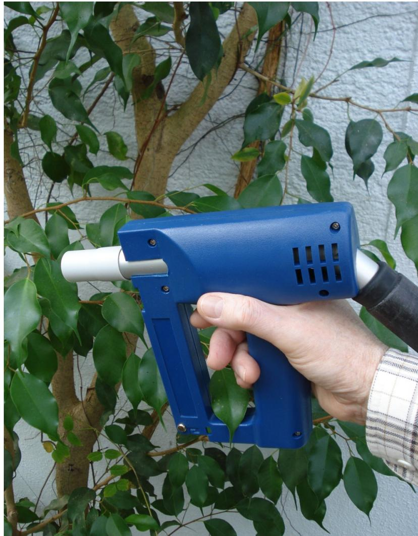
**Bild 6** Designstudie für die Fernsteuerung mit Pistolengriff und optischer Sollwerteneinstellung.
