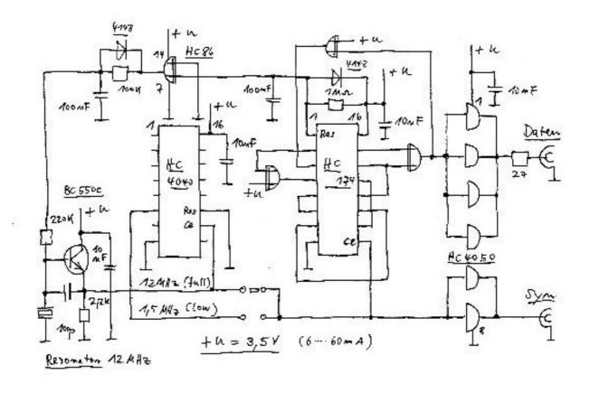
Bild 1 Schaltung des Testgenerators. Die Höhe der Versorgungsspannung ist auf den USB abgstimmt.
