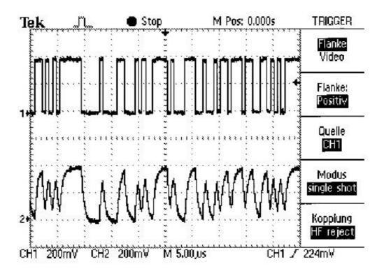
Bild 2 Ausgangssignal des Generators, hochohmig gemessen. Datenrate 1,5 Mbd / low speed.
